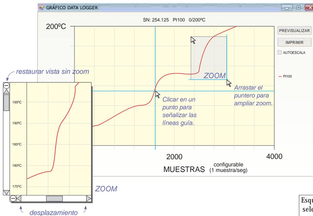
Para descargar a pantalla los datos registrados en el módulo.
