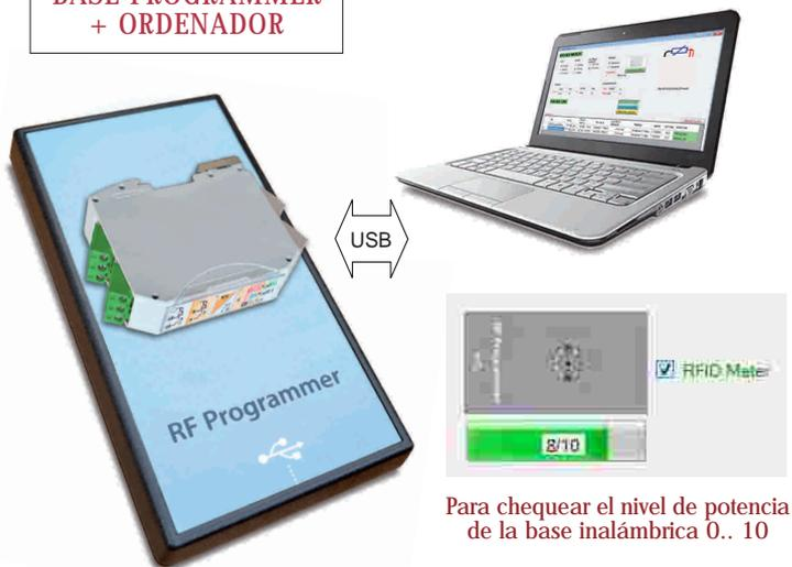
Para chequear el nivel de potencia de la base inalámbrica 0.. 10
